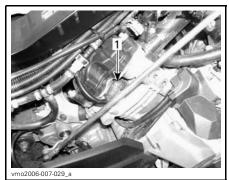
**RH SIDE — REAR CYLINDER** 1. Spark plug
